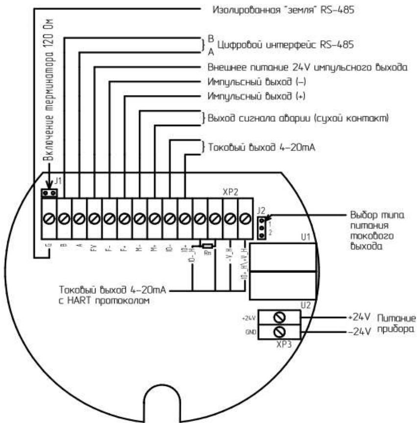
Рисунок 9 - Общий вид и назначение выходных разъемов расходомера
