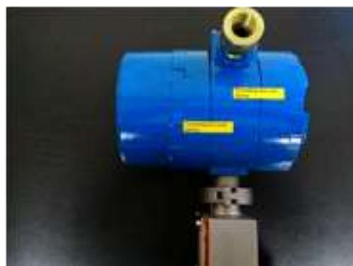
Рисунок 4 - Схема пломбировки счетчика - расходомера массового МИР:
