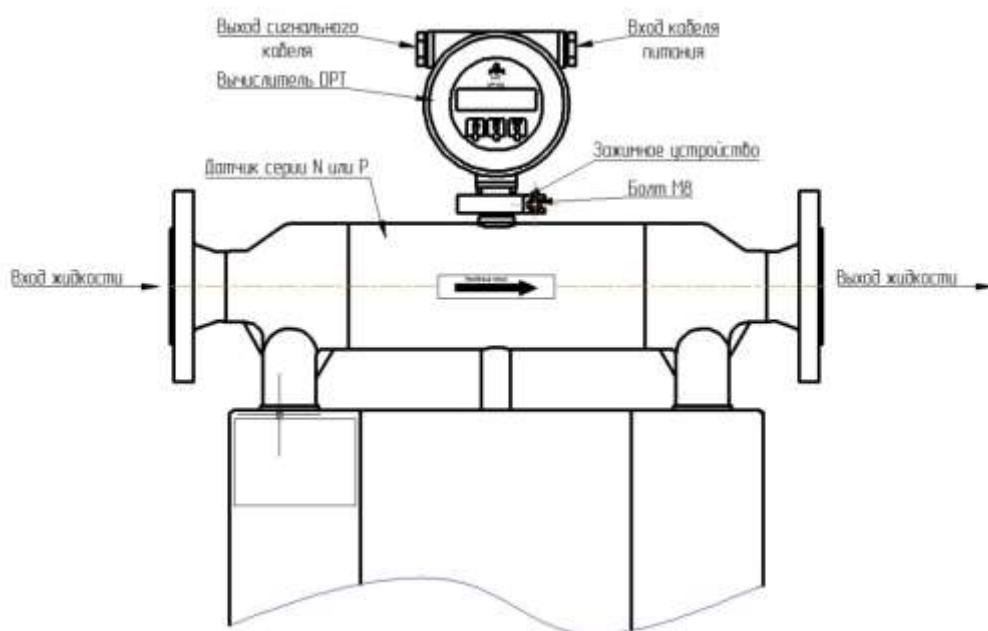
Рисунок 7- Монтаж вычислителя в компактном исполнении (до Р50)
