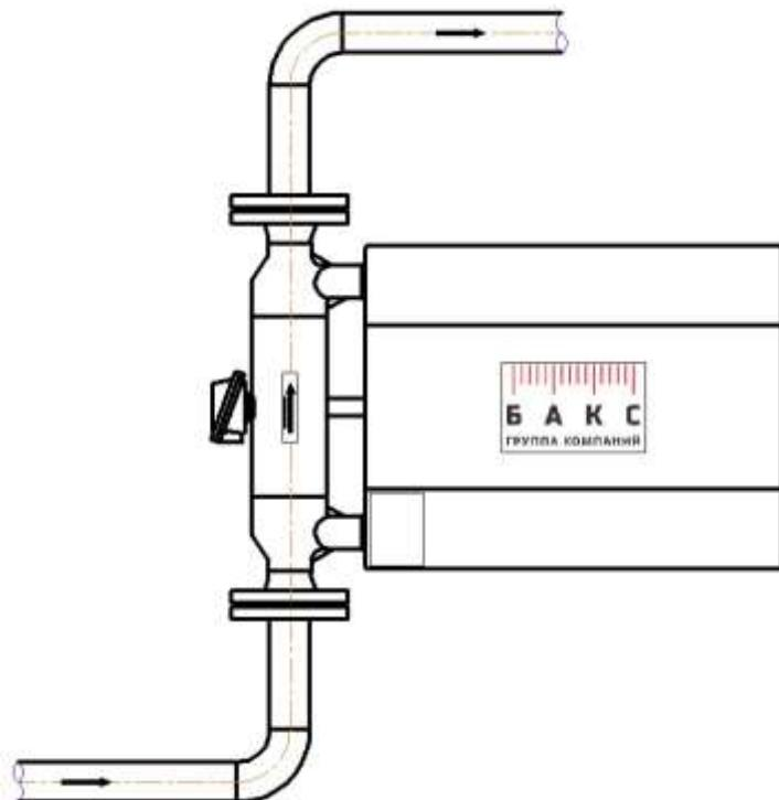
Рисунок 6- Монтаж расходомера в вертикальный участок трубопровода
