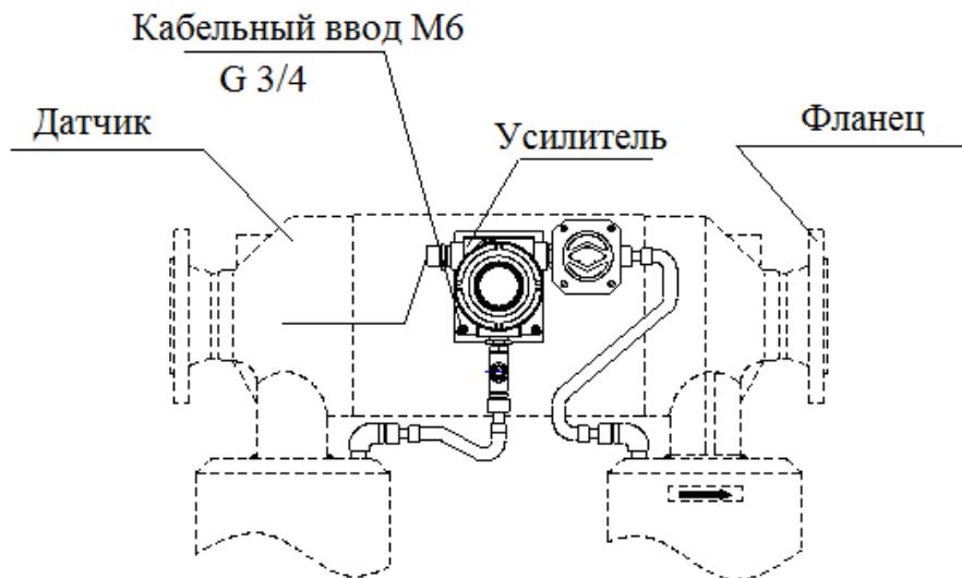
Рисунок 14 - Внешний вид и расположение усилителя на датчике
