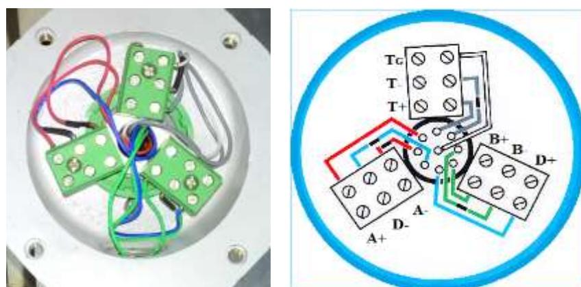
Рисунок 13- Внешний вид клеммной коробки датчика
