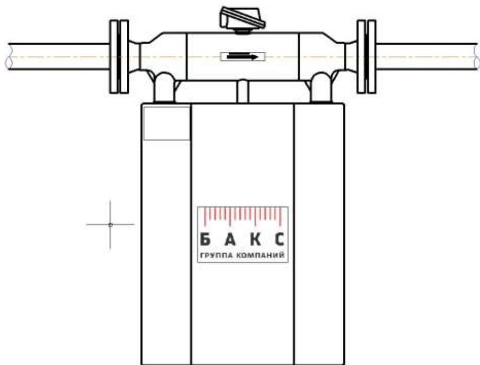
Рисунок 5- Монтаж расходомера в горизонтальный участок трубопровода
