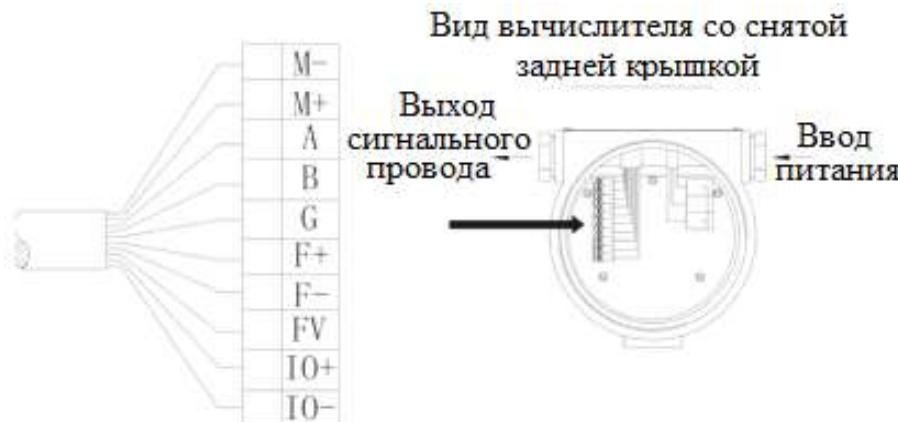
Рисунок 11 Подключение сигнальных выходов вычислителя
